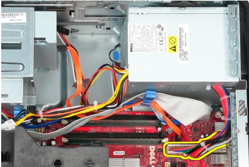
7. 전원 공급 장치 하단의 케이블 라우팅 클립에서 I/O 패널 데이터 케이블을 분리합니다.
